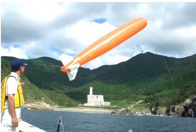
デジタルカメラ搭載のバルーン。写真は漁船から空中に流した直後。この後、高さ数 100m まで上昇させ、漁船で曳航しながら漂流ゴミを空撮
