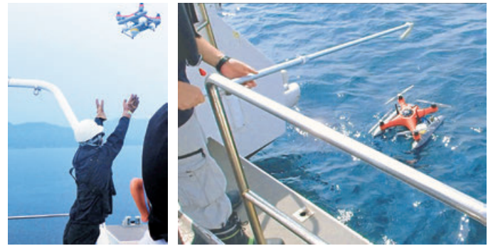
図 1. マルチコプター観測終了時の回収方法 船上で人的に捕獲する場合（左）と、水上離発着してから揚収する場合（右）。
