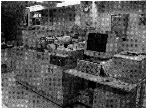
1) 高分解能ガスクロマトグラフ質量分析計：環境試料中のダイオキシン類を高精度で検出・定量する器機
