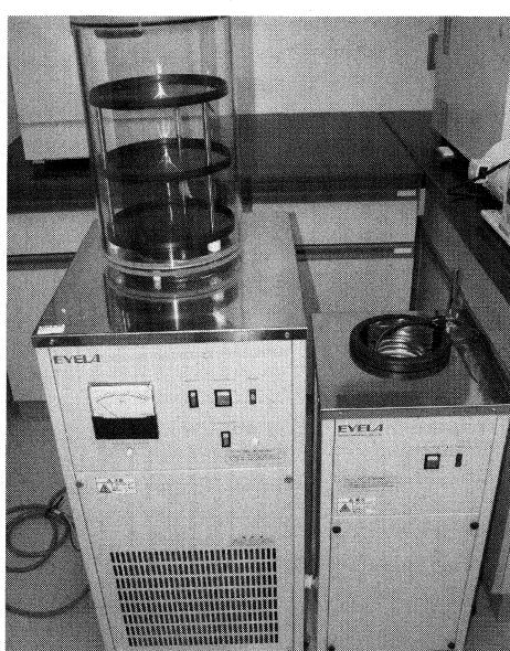
10) 凍結乾燥機：低温下で生物試料を乾燥させる装置
