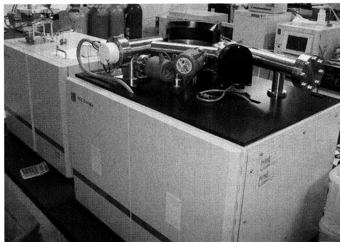
1) 安定同位体質量分析器：炭素・窒素・イオウ元素の非放射性である安定同位体比を自然存在比の精度で分析することが出来る。食物連鎖や地球生物化学的研究に応用可能である。
