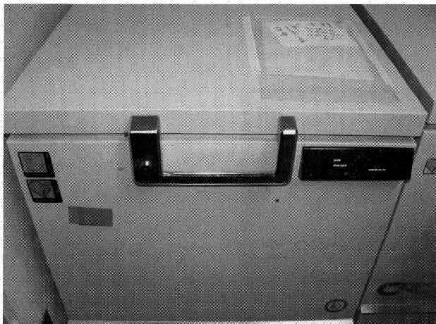
8) 超低温フリーザー：生化学試験用の生体試料を-80°Cで凍結保存する容器
