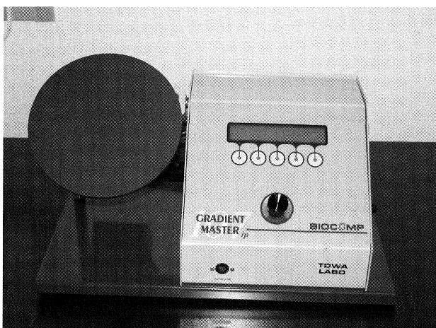
6) 生体分子分取システム：少量のペプチドタンパク質を密度勾配遠心法により分離・分取する装置
