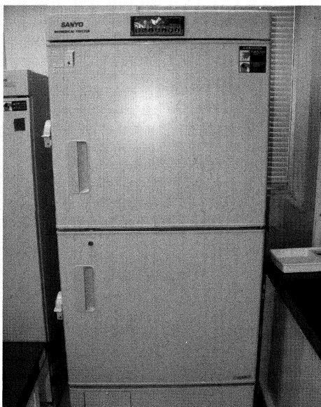
7) 冷凍庫：化学分析用の生体試料を-20°Cで凍結保存する容器
