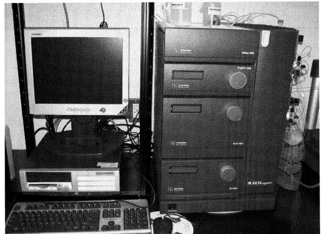
5) 生体分子精製システム：少量のペプチドタンパク質をクロマトグラフィーを用いて精製する装置
