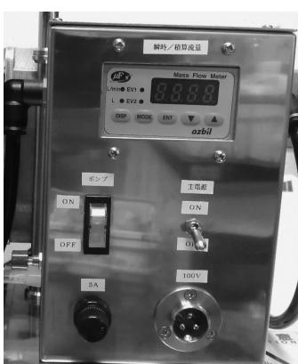
10) ローボリュームポンプ：低～中容量の大気サンプルの吸引により、揮発性有機物質等の有害物質を採取するための装置。
