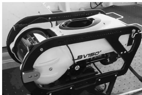
マニピュレータと対応する試料採取装置により、ピンポイントでの試料採取が可能である。(例えば、海底から湧き上がる地下水の採取など) その他に、計量魚群探知機と組み合わせて運用することにより、魚群探知機によりモニタリングされた魚や藻場の種類を特定することが可能。
