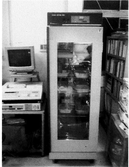
9) フラクシオンコレクター：液体クロマトグラフと連結して使用し，試料溶液中に存在する目的とする物質を含んだ画分を分取する機器である．
