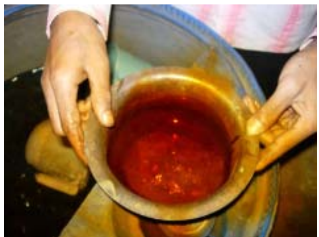
写真：バンガロールで小規模業者が行っているPC基盤処理の一例。基盤の破片硝酸に入れて分解している。激しく反応し、茶色いヒューム状の煙が発生している。
